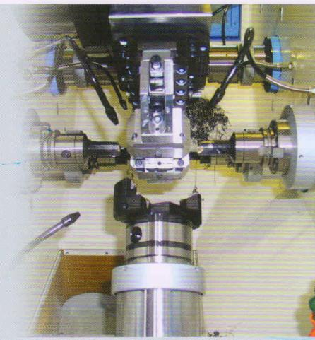
La macchina transfer **BTB TRO 8S-12U+2MC HSK63 CN-EL** è specificatamente studiata per la lavorazione di giunti cardanici in acciaio, ghisa ed altre leghe metalliche similari grazie alla speciale progettazione per quanto riguarda le potenze di lavoro, la rigidità del basamento con doppia parete, le unità a CN con vite in asse.
